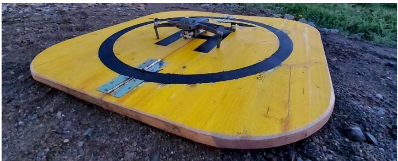
Abbildung 4: Verwendung eines Start-/Landeplatzes für den Betrieb auf unebenem Untergrund
