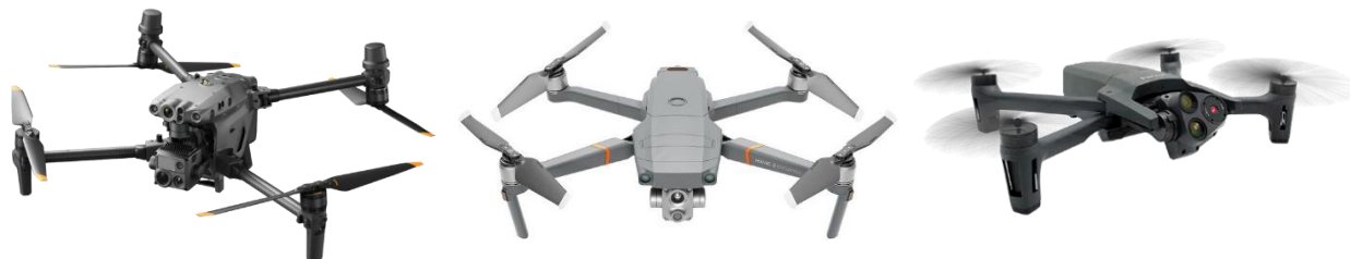
Abbildung 3: Darstellung ausgewählter Drohnen mit Multispektralkamera: DJI M30T (links), DJI Mavic 2 Enterprise Advanced (mitte), Parrot Anafi USA (rechts). Bilder: DJI bzw. Parrot
