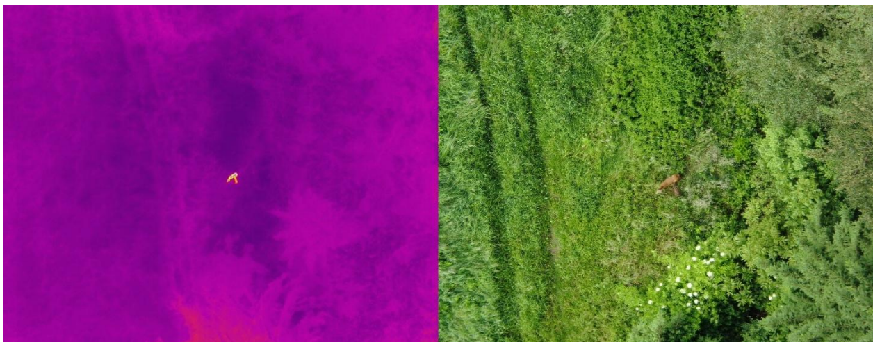
Abbildung 11: H20T-Kamera im Split View - Wärmebild und RGB-Kameraansicht
