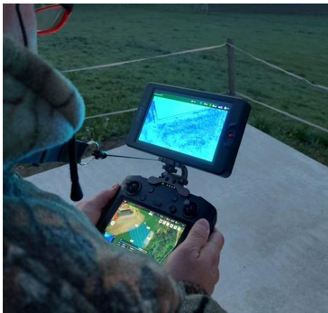
Abbildung 5: Verwendung eines zusätzlichen, größeren Displays für eine effizientere Auswertung der Infrarot-Signatur. Dabei wird das obere Display zum Aufspüren der Wildtiere verwendet, das untere Display zur Überwachung der Drohne, deren Lage und Umgebung
