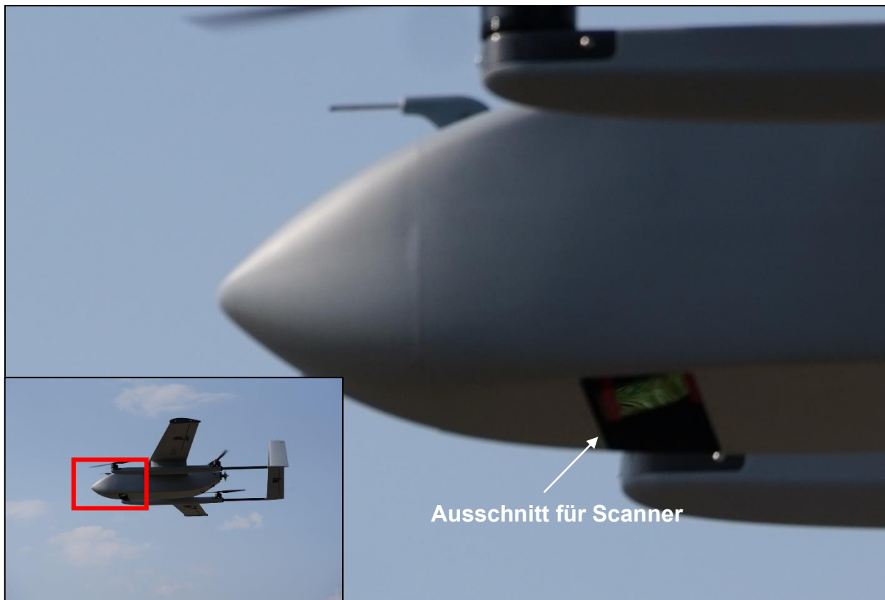
Abbildung 5: Integration des Scanners in das Fluggerät
